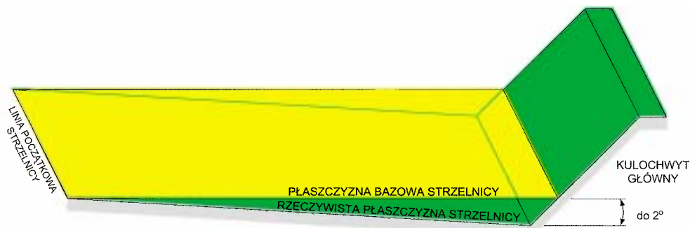
Rys. nr 1 Bazowa i rzeczywista płaszczyzna strzelnicy garnizonowej
